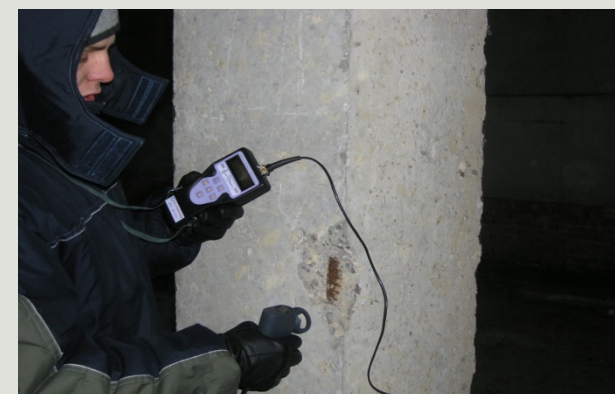
Визначення несучої здатності плити покриття
