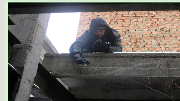
Визначення несучої здатності плити покриття
